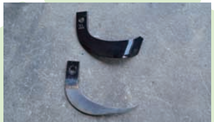
新品(上)と比べ、すり減った爪(下)では耕起に時間がかかるので交換が必要
