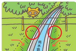
牧線が用水路の上を渡る箇所では、線の下に意外と大きな隙間ができています。
