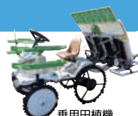
乗用田植機 ヤンマー VP1 (4条植、ロータリー式)
